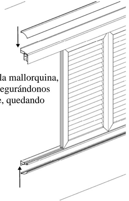
5. Para finalizar la instalación, en los carriles (superior e inferior) cliparemos los perfiles embellecedores, fijaremos los retenedores de las hojas y atornillaremos las tapetas que rematan los carriles.
