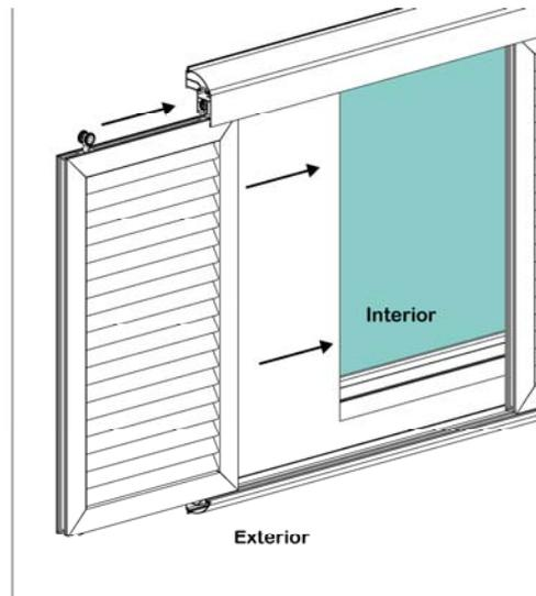
4. Volver a introducir las hojas de la mallorquina, deslizándolas por los carriles, asegurándonos de que funcionan correctamente, quedando totalmente niveladas.
