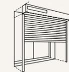
Insérez la structure dans l'ouverture de la fenêtre ou de la porte.
