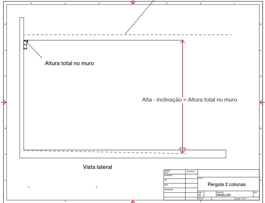
Situe as bases das colunas de acordo com as medidas do plano e com o desnível do pavimento, tendo em conta que estas devem formar um ângulo de 90° relativamente ao muro de apoio da pérgula.
