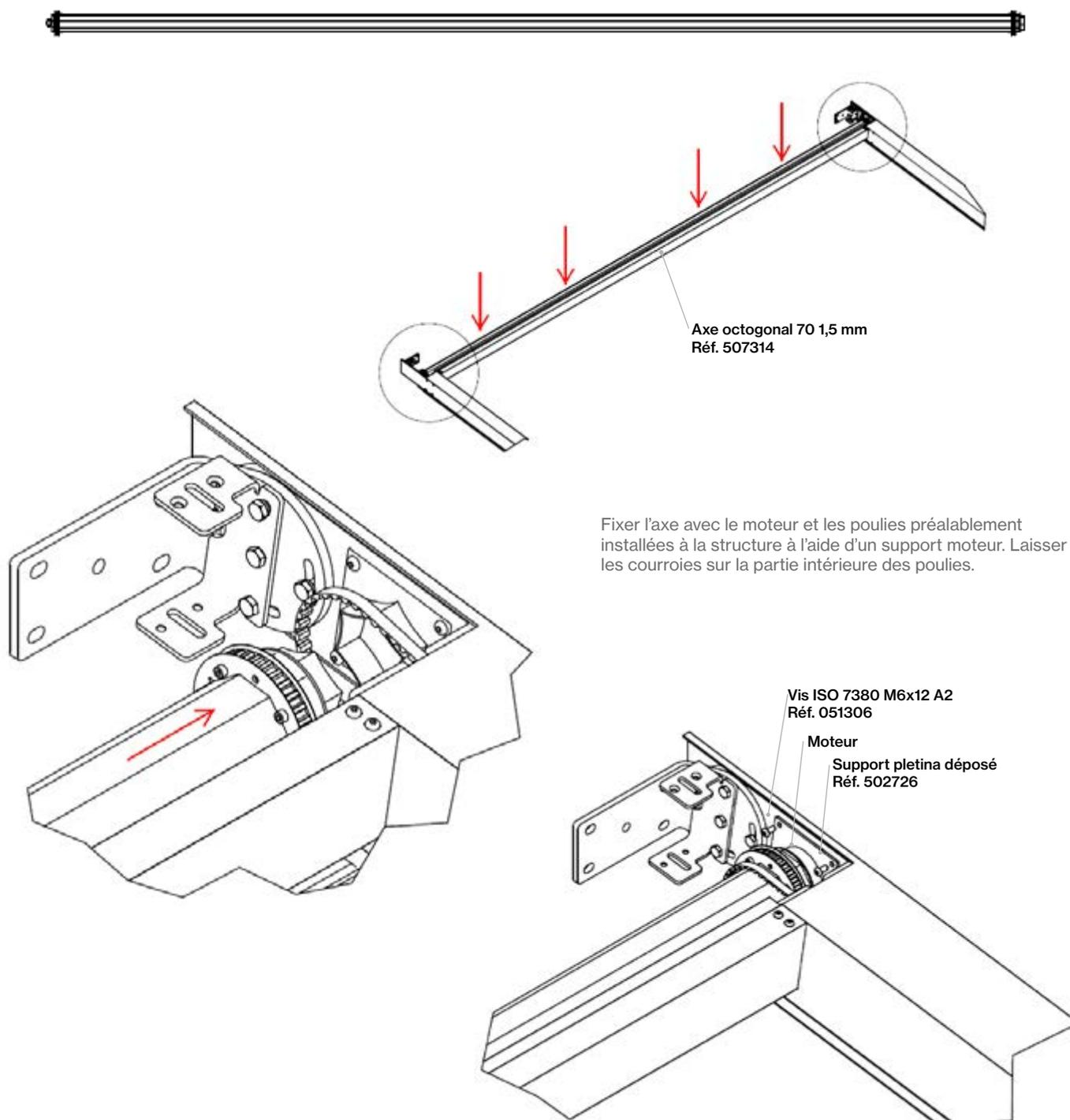
Fixer l'axe avec les poulies préalablement installées à la structure à l'aide du pivot de l'embout au support en U. Laisser les courroies sur la partie intérieure des poulies.
