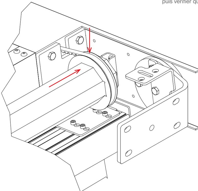
Tendre les courroies à l'aide des vis intérieures présentes sur les mini poulies, en utilisant les orifices des colonnes pour le fonctionnement correct. Tendre les courroies à parts égales, en comptant le nombre de tours de chaque vis.
