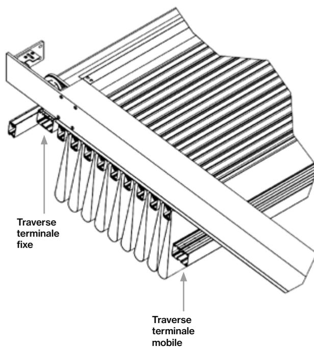
Fixer la **traverse terminale fixe** sur les poutres à l'aide du **support fixateur**.
