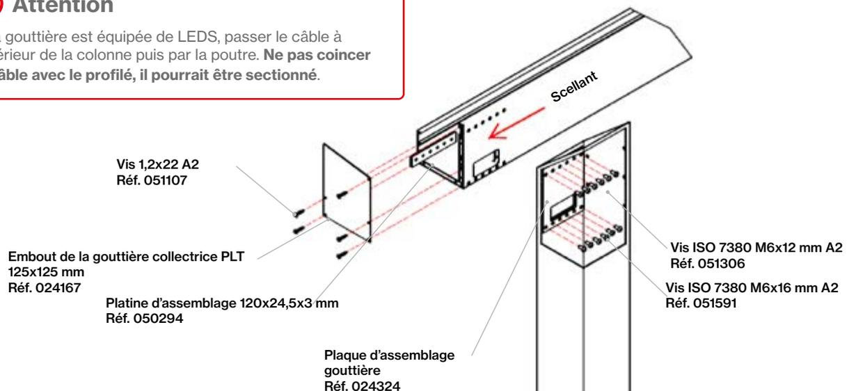
Fixer l'embout de la gouttière collectrice PLT 125x125 mm de code 024167 en utilisant les vis 4,2x22 A2 fixation de code 051107. Appliquer le produit de scellement sur la partie interne de la gouttière.
