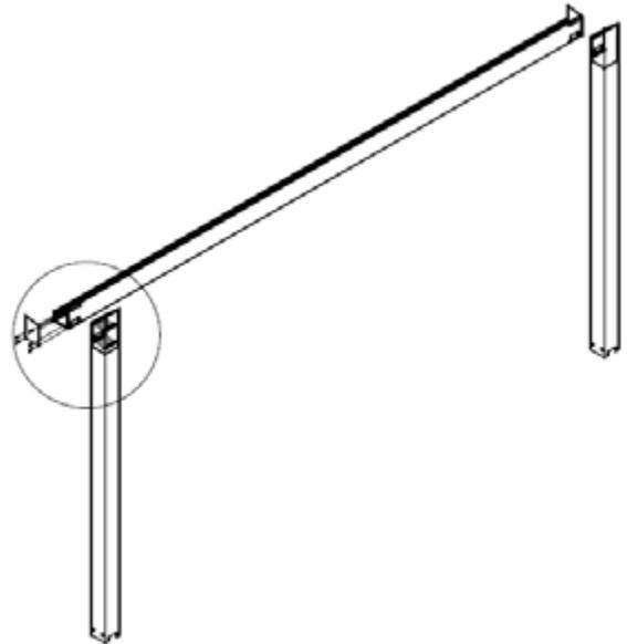
Installer la gouttière en utilisant les vis ISO 7380 M6x12 A2 de code 051306 de la partie interne de la colonne sur la file supérieure et les vis ISO 7380 M6x16 A2 de code 005591.
