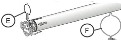
**3.3.3.** En fonction du type de support, installez l'anneau de butée (E) (dans le cas des moteurs à 85 Nm, avec un anneau de butée, on utilise obligatoirement l'anneau de butée verrouillable (F).
