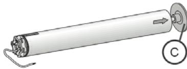
**3.3.1** Montez l'ensemble tube-moteur sur le support de l'extrémité (C).
