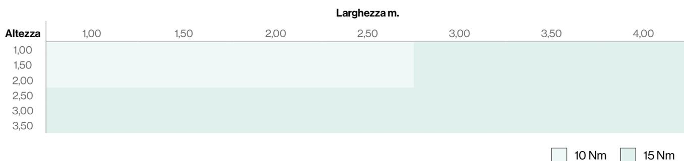
**Wind Screen 125 • Selezione del motore secondo il tubo di avvolgimento ø100 mm**
